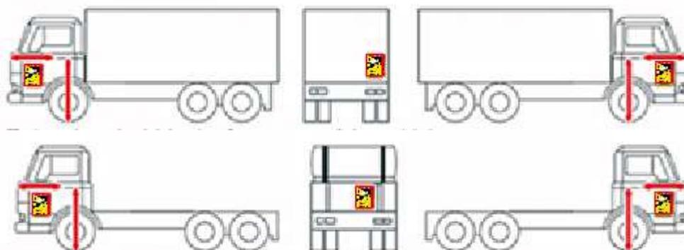
Sulle fiancate del veicolo (a destra e sinistra): 2 adesivi sul primo metro anteriore del veicolo, 1 a sinistra e 1 a destra e ad un'altezza compresa tra 0,90 e 1,50 m da terra.
