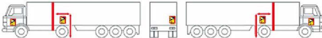
Sulle fiancate del semirimorchio: 2 adesivi sul primo metro anteriore dietro il perno di sterzo del veicolo, cioè 1 a sinistra e 1 a destra e ad un'altezza compresa tra 0,90 e 1,50 m da terra.
