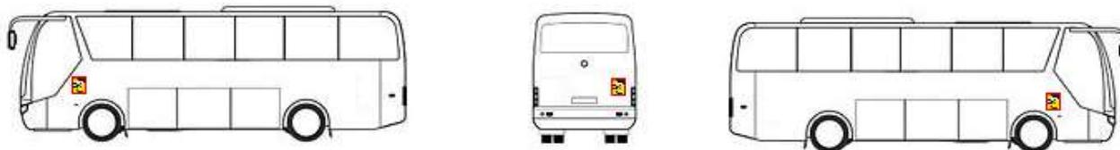
Sulle fiancate del veicolo: 2 adesivi sul primo metro anteriore del veicolo, 1 a sinistra e 1 a destra e ad un'altezza compresa tra 0,90 e 1,50 m da terra.
