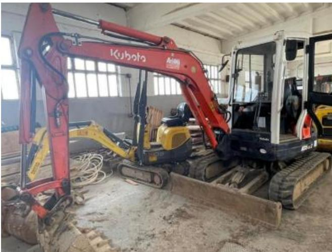
DESCRIZIONE: n.1 Escavatore cingolato gommato q.li 35 U35-3alfa Kubota con 2831 ore moto, completo di benna larghezza 40 cm, martello demolitore idraulico Indeco 650 e cingolato gommato nuovo (ulteriori informazioni sono rilevabili dal certificato di conformità allegato alla [perizia](#)), in discreto stato manutentivo. VETUSTA': immatricolato nel 2005.
