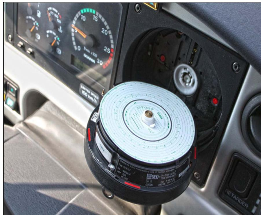
I dischi di registrazione vanno **sostituiti nel cronotachigrafo ogni 24 ore** e non alle ore 24.00 di ogni giorno.
