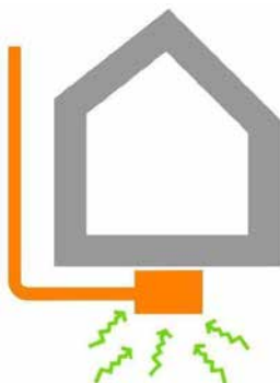
Figura 16: depressione del sottosuolo tramite pozzetto.
