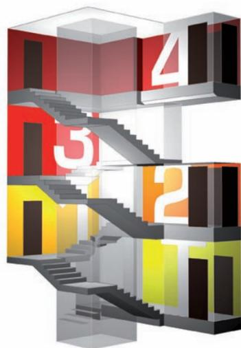
Le due ali originariamente differivano sia per la distribuzione verticale (interna nell'A ed esterna nella B) che per la composizione dei livelli interni che- di conseguenza- per le quote interne dei solai, con la sola eccezione della quota del solaio del piano sottotetto e della linea di colmo, che coincidevano in entrambi i nuclei. In sede di progetto si è
