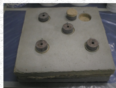
Fibra di legno Rottura pannello
